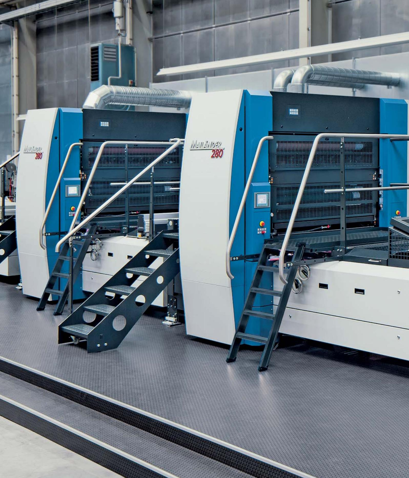
Mit der Mailänder 280 hat die KBA-MetalPrint GmbH im Berichtsjahr eine Blechdruckanlage vorgestellt, die besonders dicke Blechtafeln bedrucken kann und der wachsenden Nachfrage aus Schwellenländern Rechnung trägt
