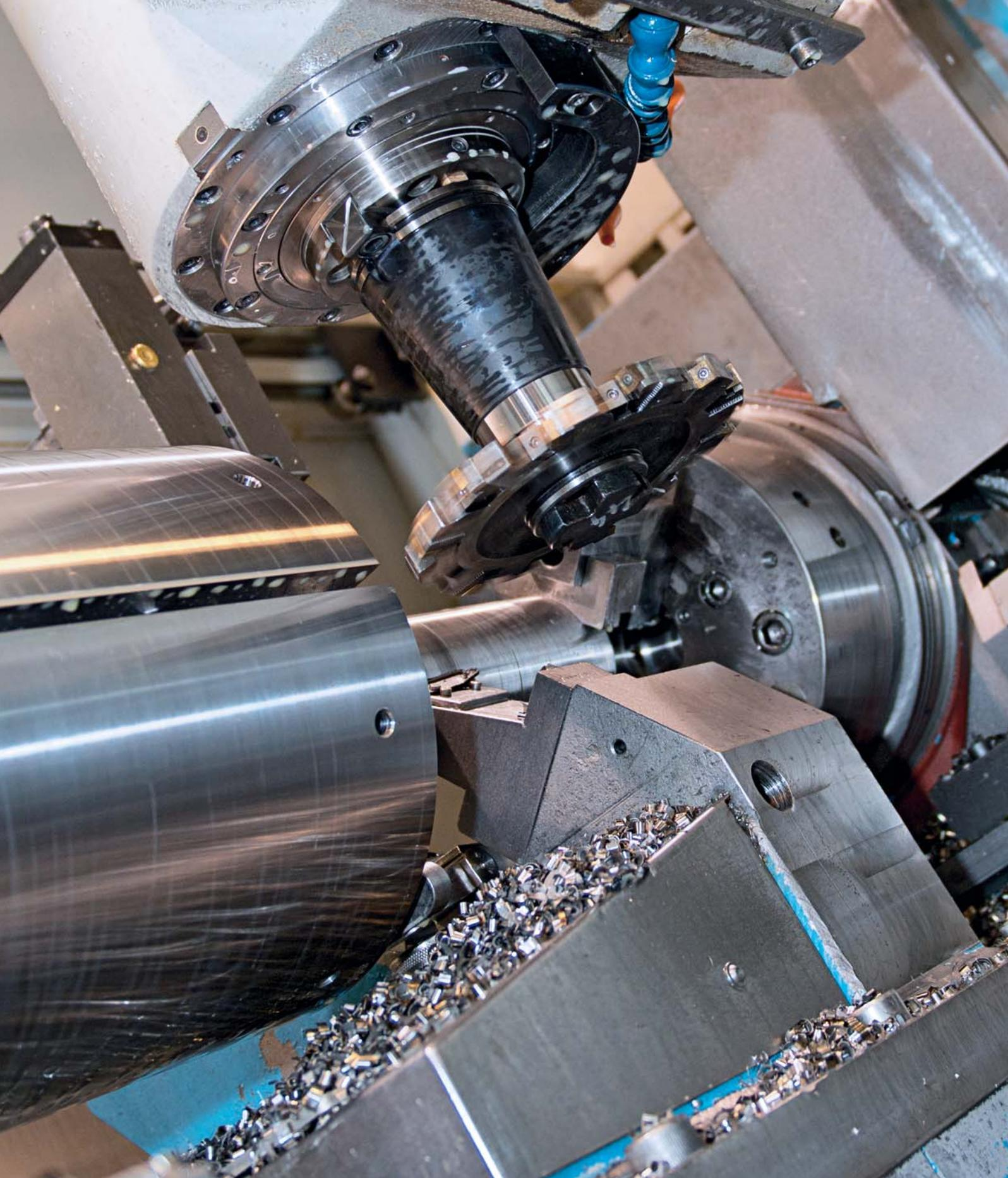
In der mechanischen Fertigung will sich KBA künftig verstärkt auf Kernkomponenten konzentrieren. Dazu zählen auch hochpräzise Zylinder wie hier im Bild
