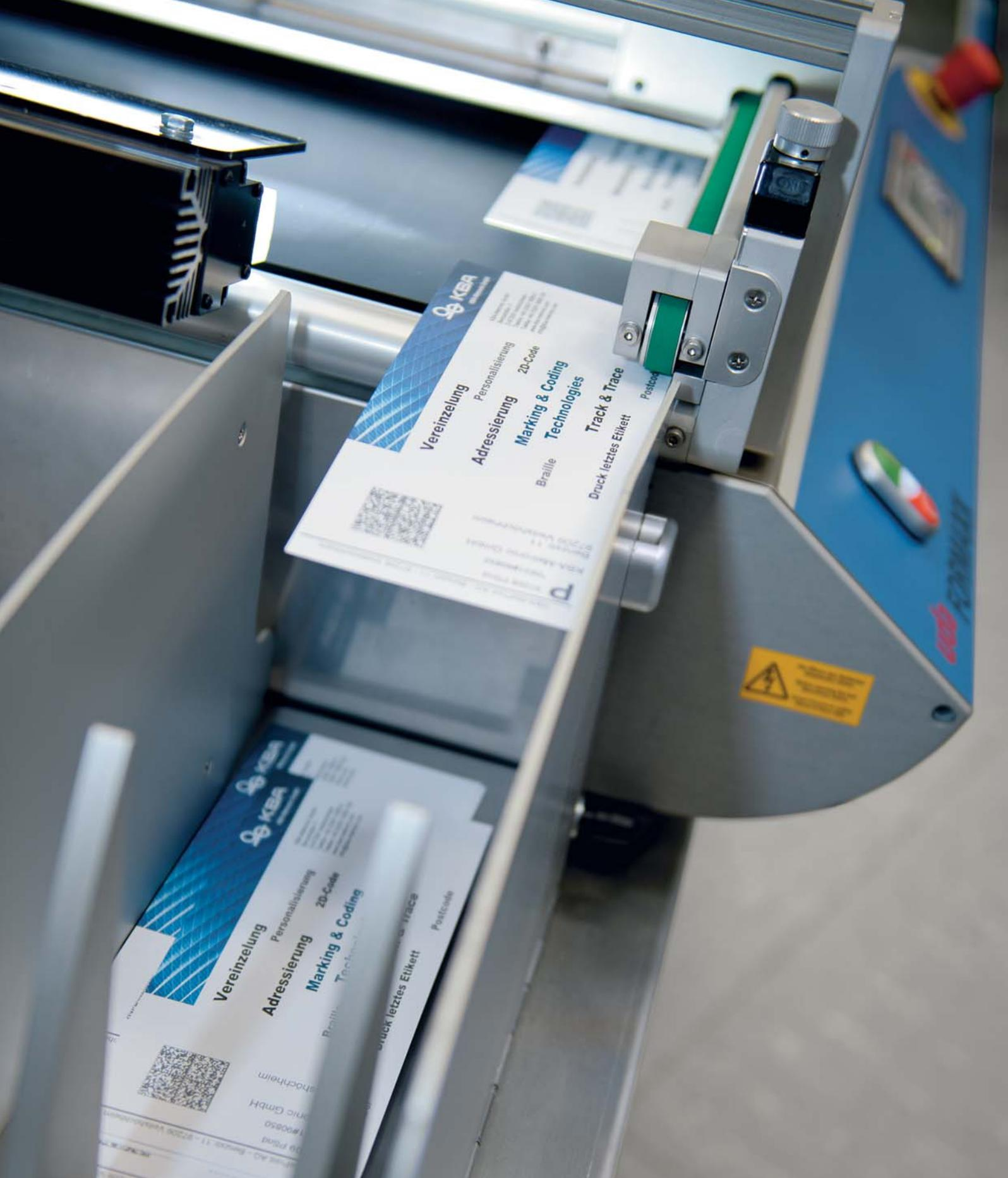
Das mit Inkjet-, Laser-, Heißpräge- oder Thermotransfertechnik konfigurierbare Vereinzelungssystem udaFORMAXX von KBA-Metronic kann Faltschachteln, Etiketten, Blister- und ISO-Karten in kleinen Auflagen kennzeichnen und beschriften
