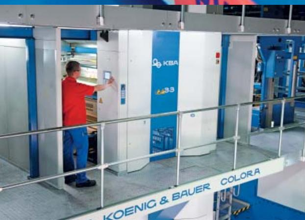
In Schwellenländern mit begrenzten Druckkapazitäten werden Schulbücher häufig noch auf klassischen Zeitungsrotationsanlagen produziert. Moderne Technik wie in diesem Fall eine Achterturmmaschine KBA Colora in Ecuador ermöglicht die erforderliche Qualität
