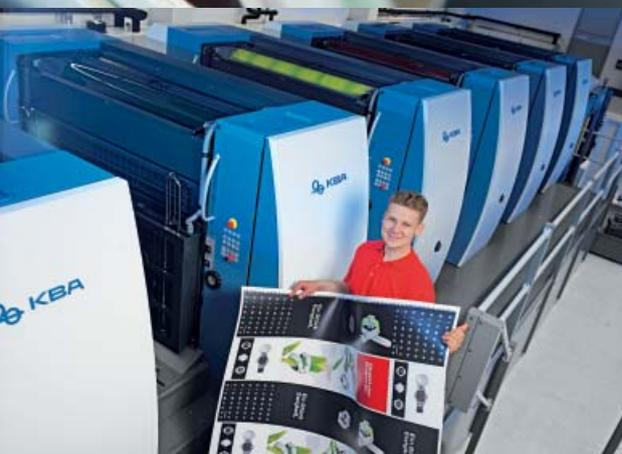
Der Druck auf biegesteifen Materialien wie z. B. Bierfilz ist eine besondere Spezialität der großformatigen KBA Rapidas. Im Werk der Katz-Gruppe im baden-württembergischen Weisenbach und an drei anderen Standorten werden auf modifizierten Anlagen der Baureihe KBA Rapida 130 über 30 Mrd. Bierdeckel jährlich produziert
