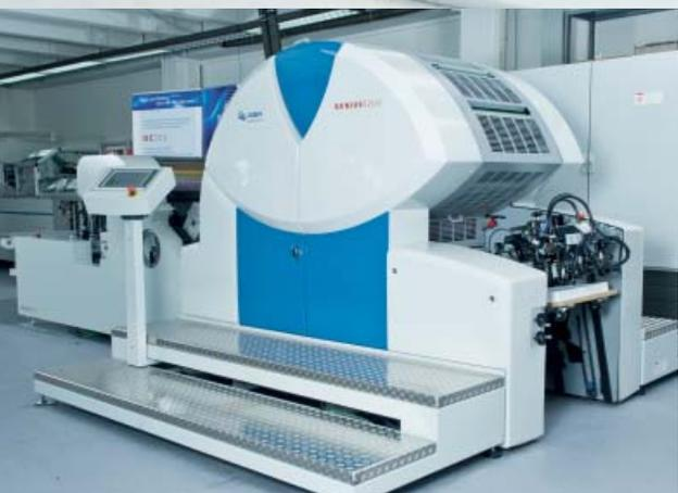
Beim UV-Druck auf teuren Folien punktet die kleine A3-Maschine Genius 52UV von KBA-MePrint mit wenig Makulatur, schnellen Jobwechseln und exzellenter Qualität. Dazu produziert sie auch noch sehr umweltfreundlich im wasserlosen Offsetverfahren
